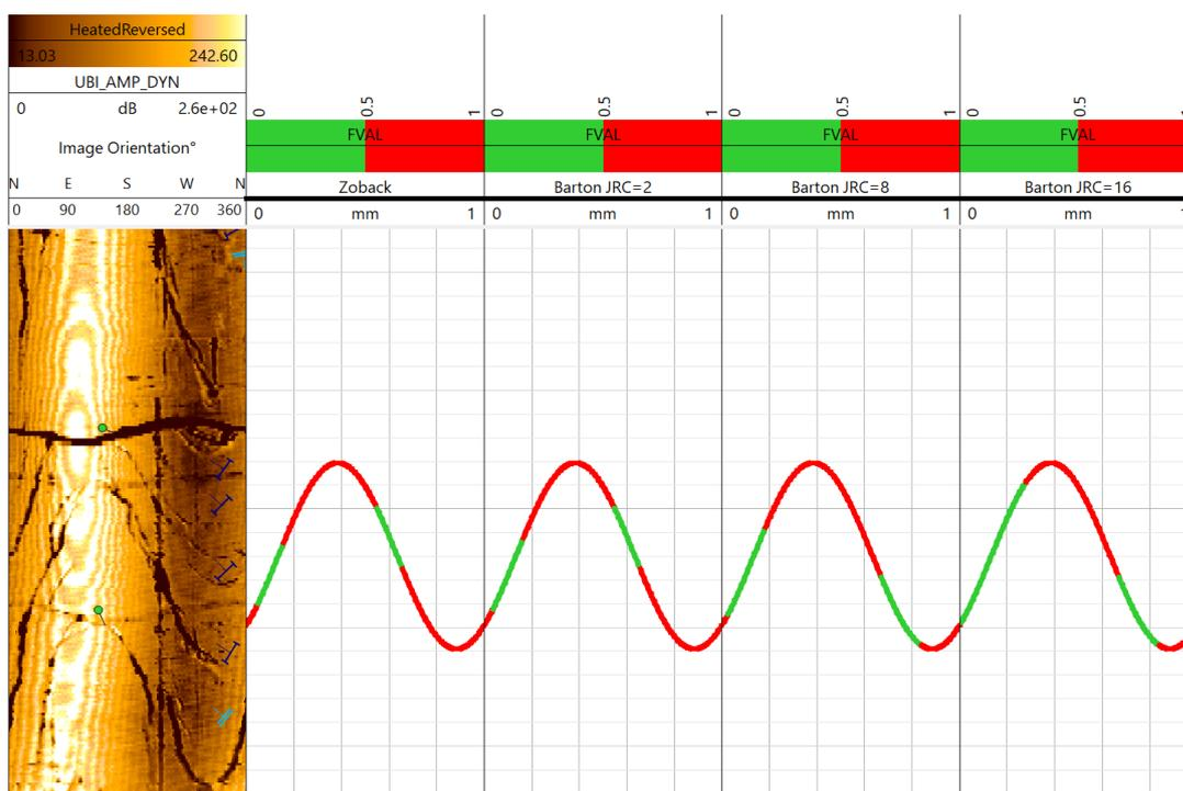
Рисунок 6 Трещина на глубине 2367,7 м результаты активности/критической напряженности для критериев
